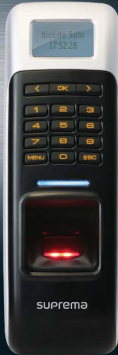
**BioLite Solo** es un dispositivo autónomo de control de acceso, fácil de usar, que ofrece la conveniencia y seguridad de la tecnología biométrica. La pantalla LCD y el teclado facilitan el alta o eliminación de los usuarios, sin necesidad de conectarse a una PC. Está diseñado para exteriores, por lo que es la solución ideal para control de accesos en oficinas pequeñas, tiendas o residencias, ya sea para uso en interiores o exteriores.
